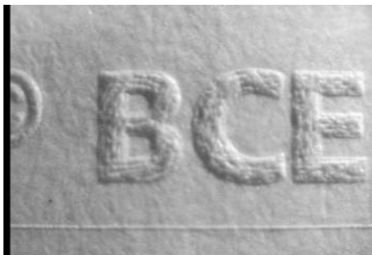
Figure 21 - Euro, intaglio relief in IR mode.
